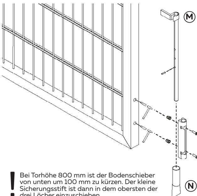
Bei Torhöhe 800 mm ist der Bodenschieber von unten um 100 mm zu kürzen. Der kleine Sicherungsstift ist dann in dem obersten der drei Löcher einzuschieben.
