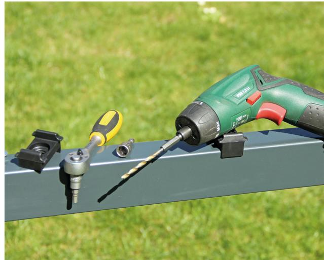
Neben dem Umbaueset benötigen Sie nur noch einen **4 mm Metallbohrer** und einen **Steckschlüsseinsatz** (10 mm Nuss) für einen Akkuschauber oder eine Hebelumschaltknarre.
